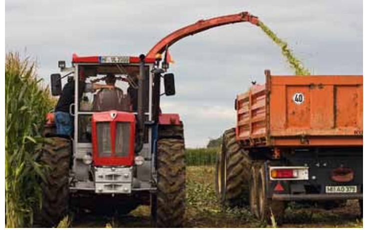
Raffinesse: Gedrehter Führerstand für bessere Sicht bei der Arbeit
