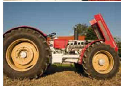
Reparaturfreundlichkeit: Der große Sechszylinder ist gut zugänglich.
